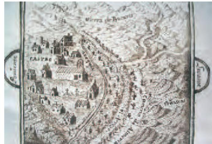
9.44 El sistema de riego que muestra el dibujo del Catastro de Ensenada de Castro era el heredado de la edad media: una simple presa de derivación toma el agua del pequeño arroyo y la lleva a una acequia que permite regar los bancales situados junto al mismo
