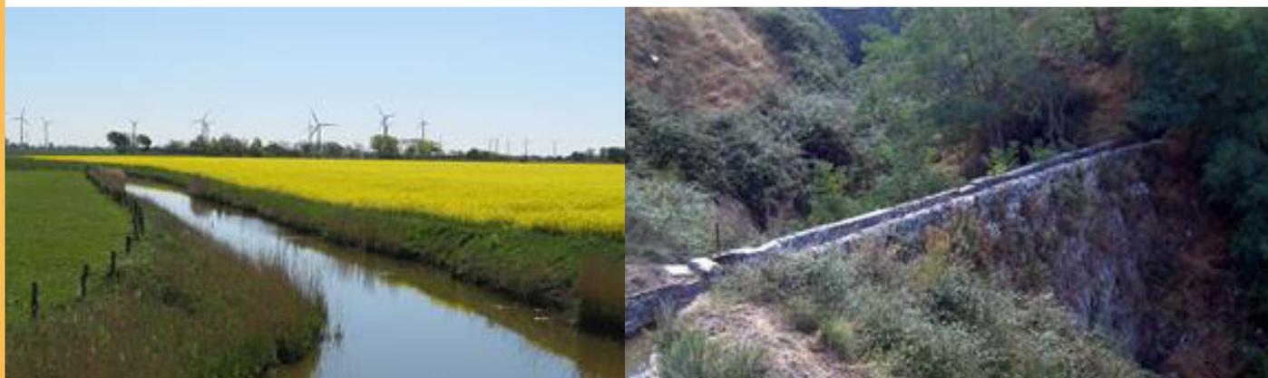
**Figura 8.** Ejemplo de dos acequias diferentes en Alemania (izquierda) y España (derecha). La imagen de la izquierda está formada por materiales naturales y tiene márgenes con una pendiente suave y la derecha es artificial con pendientes de 90 grados. Fuente izquierda: [Dirk Ingo Franke \(CC BY-SA 3.0\)](#). Derecha: Javier Martin.
