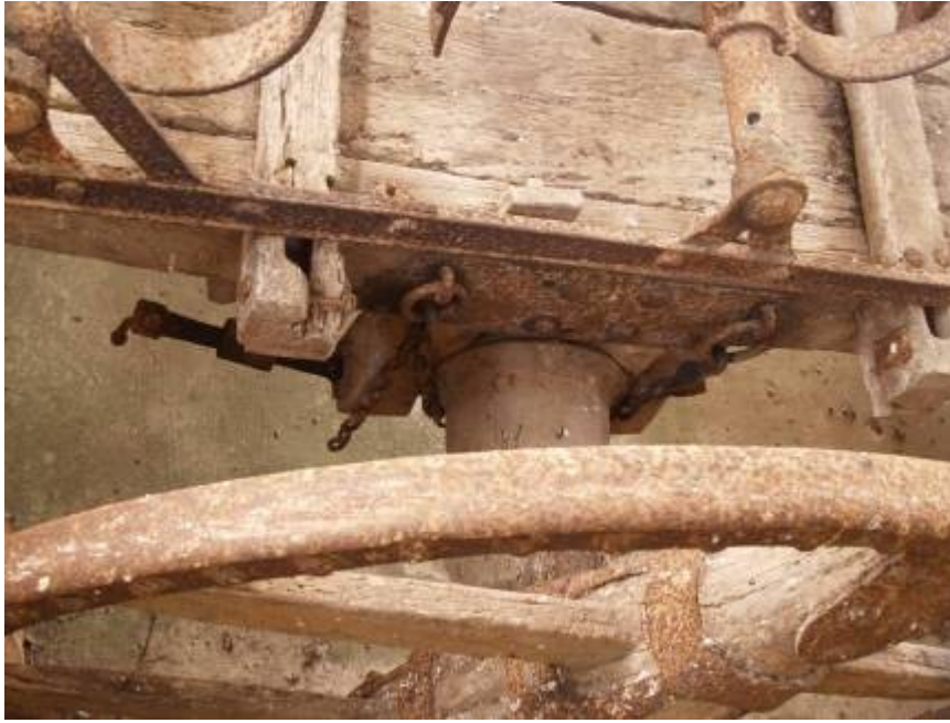
Carro del país, con detalle de la “exa” de madera y freno de zapata.
